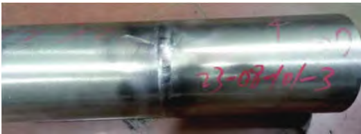
图2 焊接接头宏观形貌
