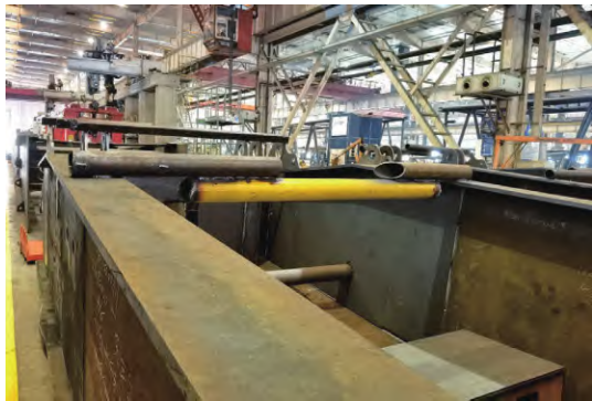
图1 现有技术采用拉筋形式
