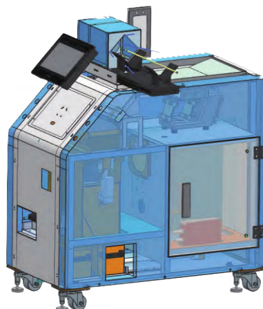
图3 焊接材料智能发放回收终端设计图
