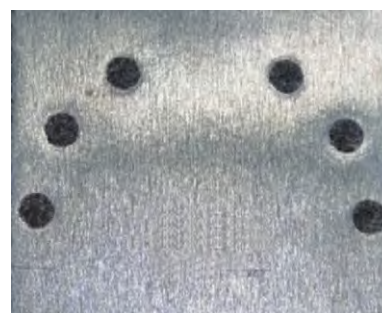
a) 铝侧焊缝外观
