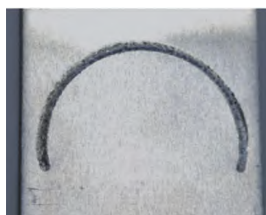
a) 铝侧焊缝外观
