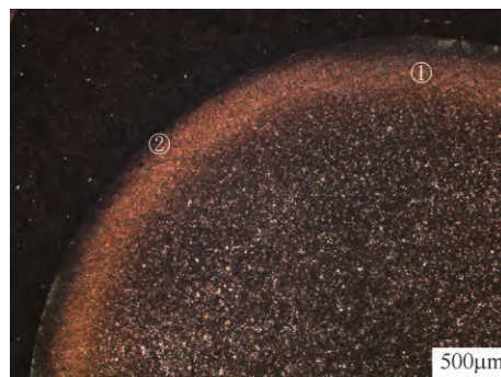
图6 表面硬度不合格锁止销的金相形貌
