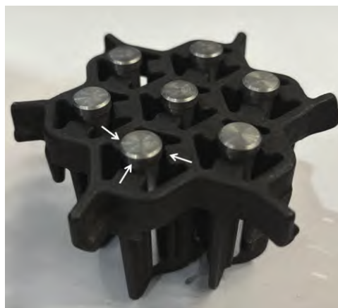
图5 锁止销渗碳热处理备料工装
