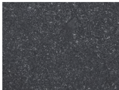
图7 齿顶淬火+回火后金相组织
