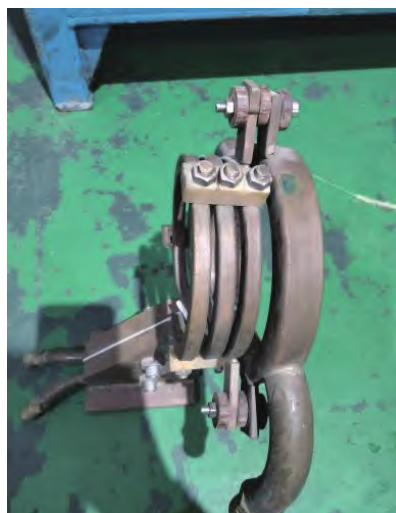
图4 \phi 63\text{mm} 滚珠丝杠中频感应淬火试验用感应器
