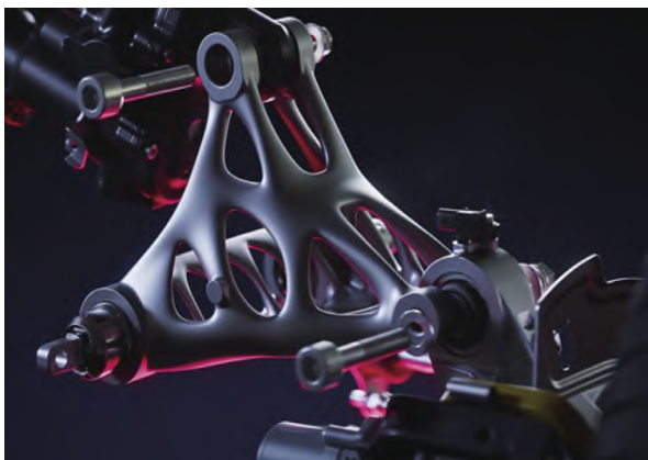
图2 法拉利F80超级跑车的钛合金部件
