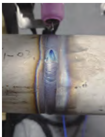
图15 焊后成形效果
