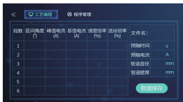
图8 分区焊接操作界面
