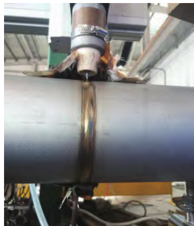
图8 316L不锈钢管对接K-TIG焊现场应用
