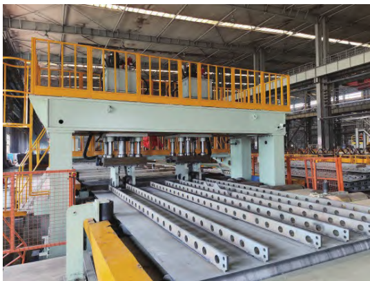
图4 板单元数控冷矫正机床工作实景
