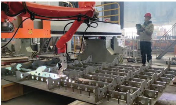
b) 机器人焊接剪力钉
