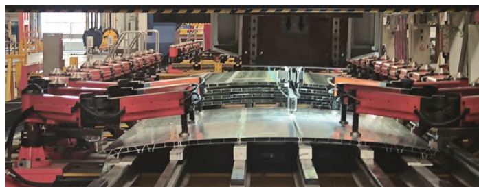
图4 顶盖搅拌摩擦焊工装正装实物
