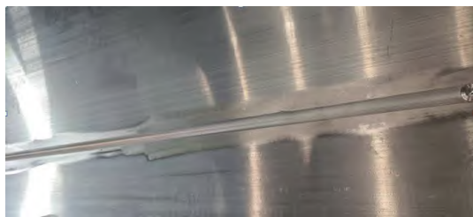
图5 顶盖搅拌摩擦焊焊缝外观
