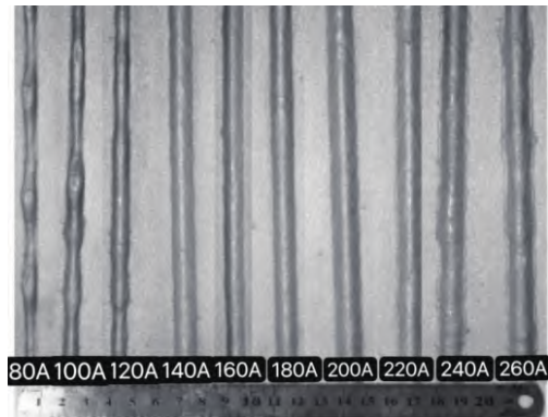
图2 不同焊接电流的焊缝表面形貌
