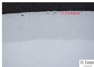
图4 金相显微镜下渗氮层抛光态沿晶裂纹形貌
