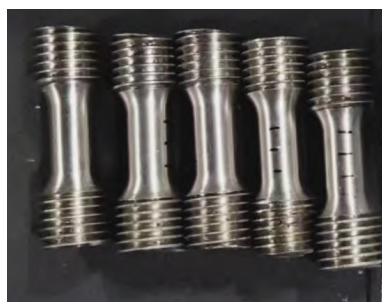
图1 A286合金拉伸试样
