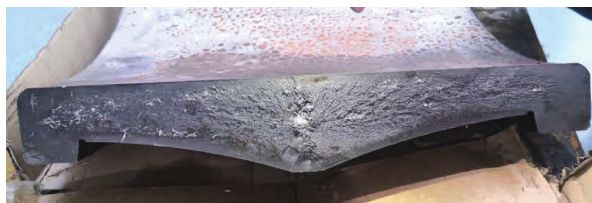
图2 内圈断口整体形貌
