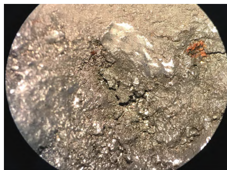
图4 断裂源处缺陷形貌
