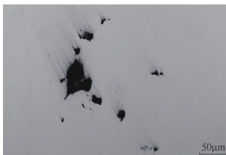
图5 缺陷处金相形貌
