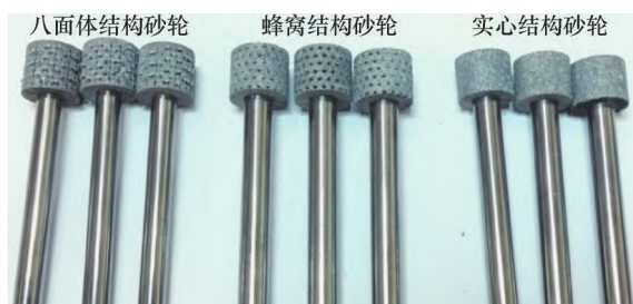
c) 八面体、蜂窝和实心结构砂轮
