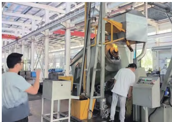
图6 90kW滚筒式淬火炉
