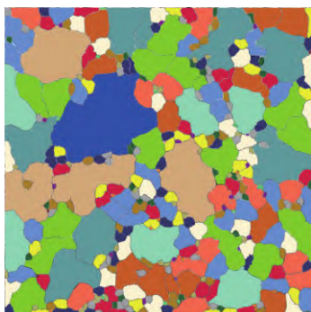
b) 1 # 试样奥氏体晶粒晶界重构图
