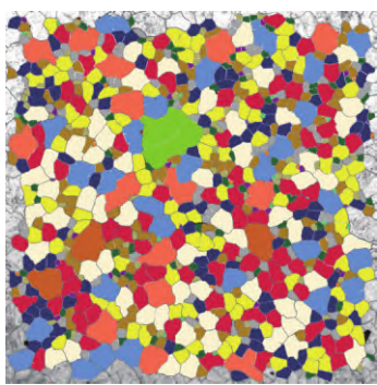
e) 2 # 试样奥氏体晶粒晶界重构图
