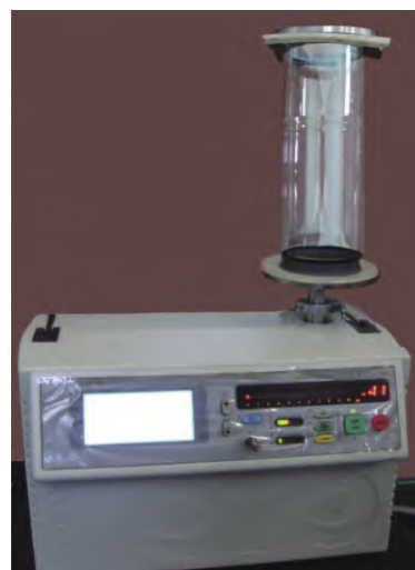
图10 玻璃金属封接体的真空气密性测试设备
