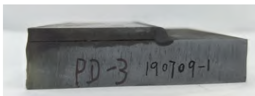
a) 接头类型a2、焊接位置PD
