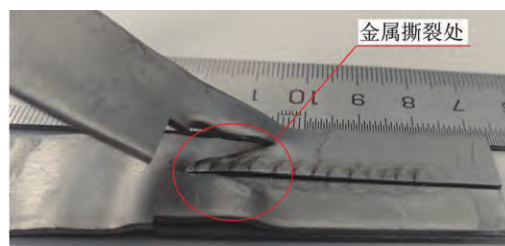
a) 试样撕破试验
