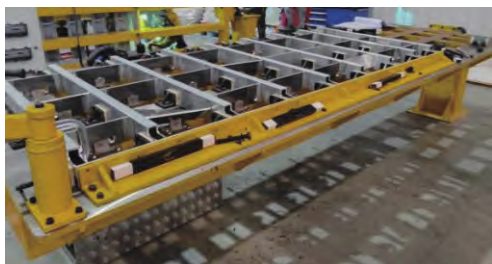
图2 支撑骨架组焊工装
