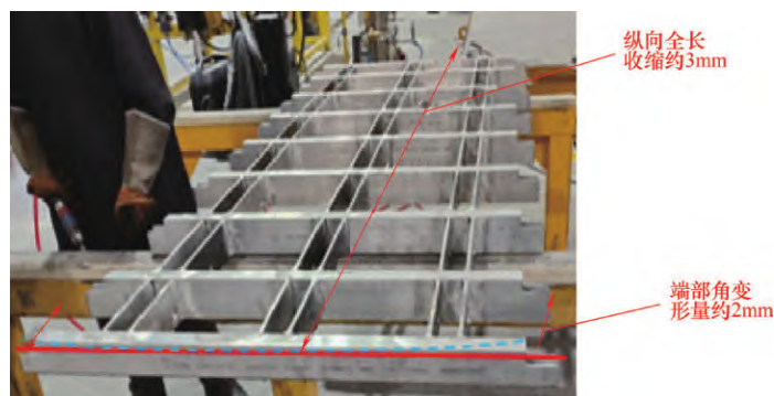
图4 支撑骨架焊后变形
