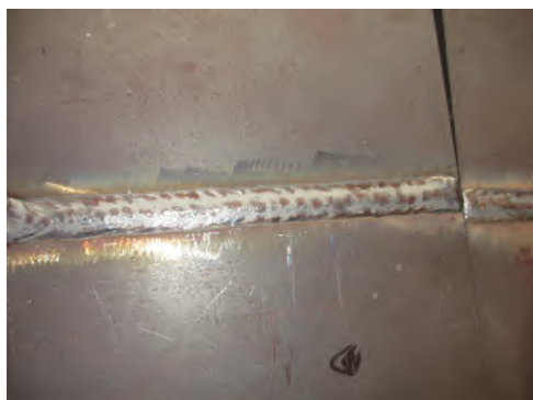
图3 金属粉芯焊丝焊接试板外观
