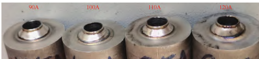
图16 不同焊接电流下的焊缝成形
