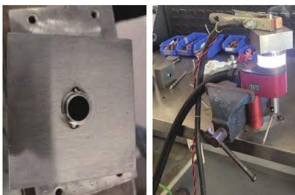
a) 组对定位效果 b) 仰焊位置焊接可行性验证
