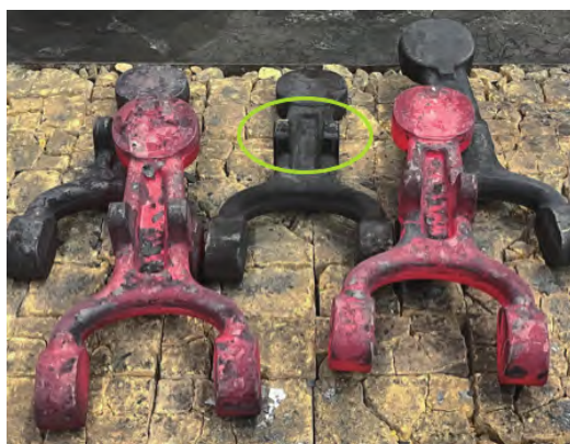
图8 上横臂锻件 (凸耳变形)
