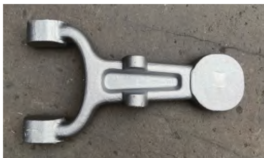
图9 上横臂锻件 (已校正)
