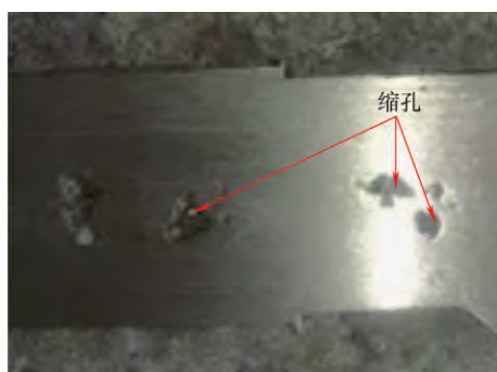
图2 原工艺局部缩孔
