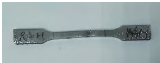
图9 拉伸试样断后情况
