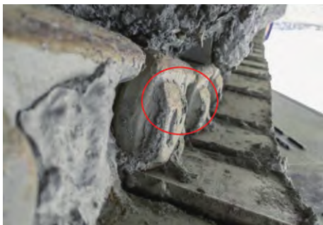
图7 销端凸台异常磨损
