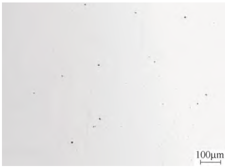
图7 非金属夹杂物微观形貌
