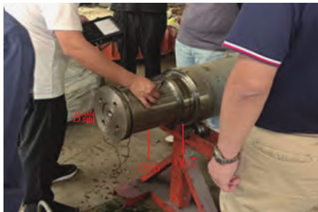
图4 现场超声波检测及分段区域（A端）
