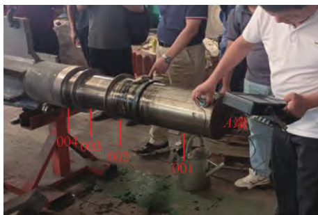
图5 现场超声波检测记录分段区域（B端）
