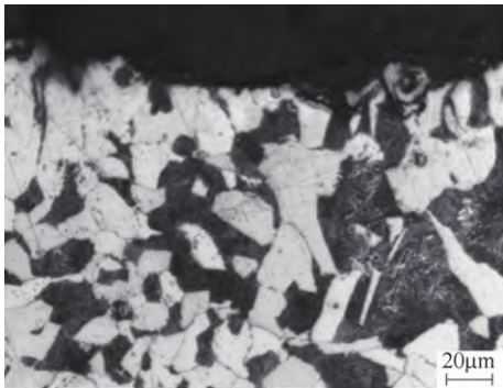
图9 电动机主轴裂纹处金相组织 (500×)
