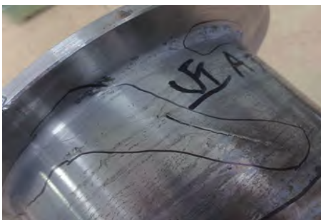
图2 呈45° 裂纹和轴肩处X形裂纹
