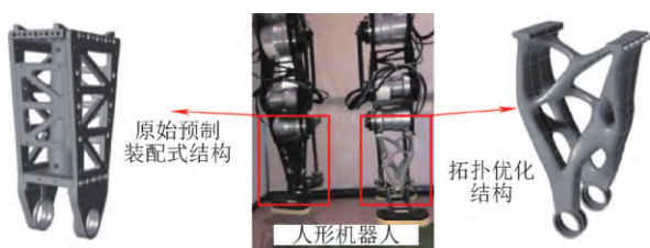
图22 仿人形机器人小腿试验打印装配 [72]
