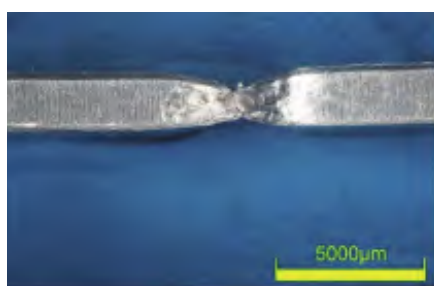
b) PZX-1-L1拉伸试样断裂形貌
