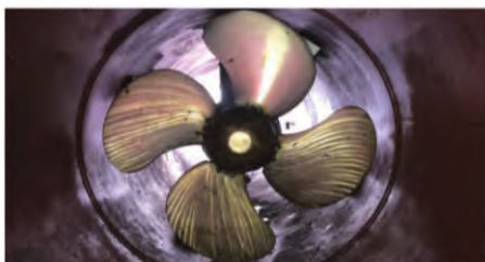
图6 镍铝青铜合金螺旋桨叶片
