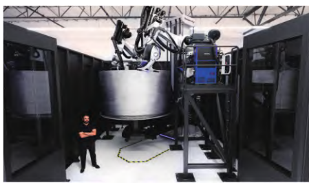
图5 Stargate金属3D打印系统
