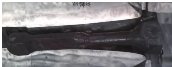
图7 TC4钛合金叶片坯料
