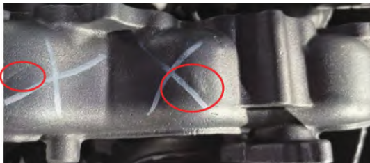
图5 管身冷隔起皮缺陷
