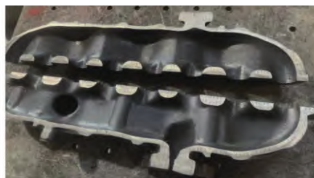
图11 解剖后热节区无缩松
