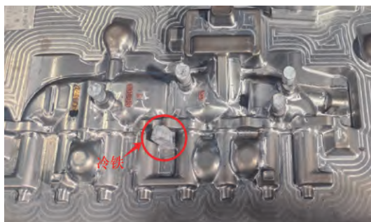
b) 下型板冒口配合冷铁工艺
