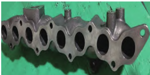
图12 加工面无缺陷
