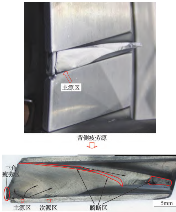
图1 断口整体宏观形貌
