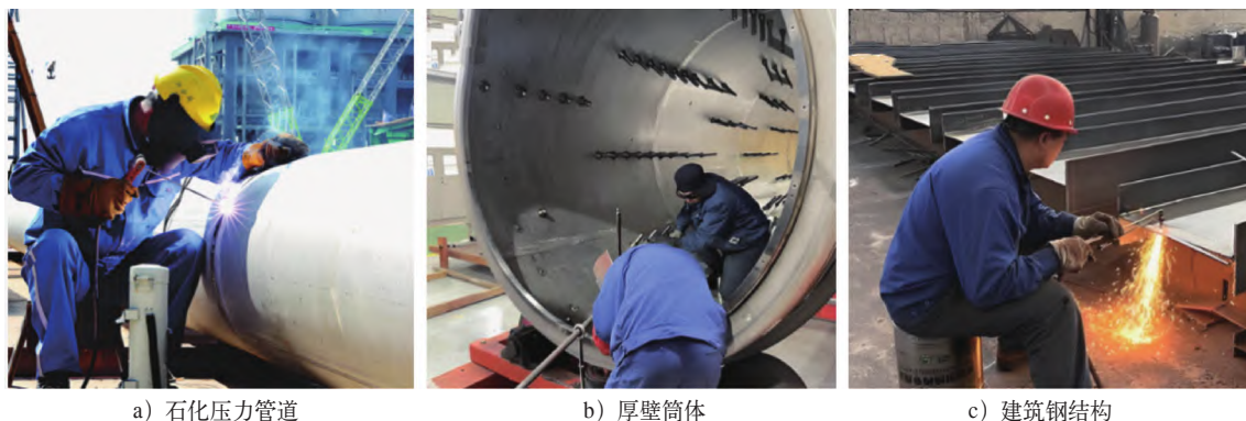
图1 常见厚壁高压承载结构件
