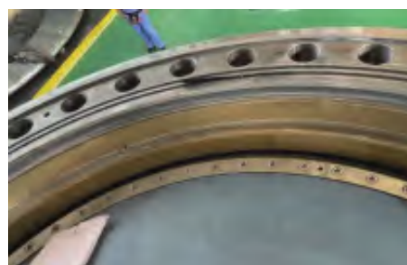
图2 球阀密封环导向面铝青铜堆焊层
