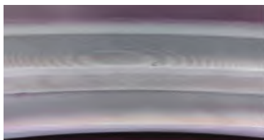
图12 球阀铝青铜堆焊层加工后PT检测结果
