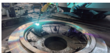
图11 上下游法兰脉冲MIG机器人铝青铜堆焊
