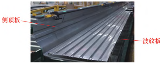
图10 侧顶板与波纹板焊接
