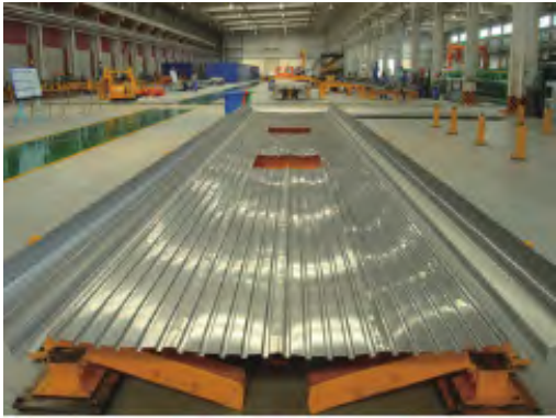
图13 焊后波纹板实物
