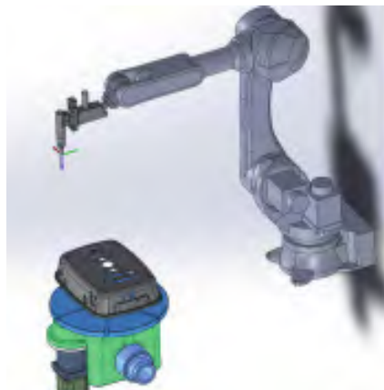
图1 机器人离线编程虚拟场景
