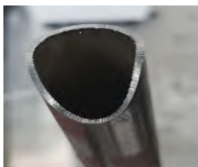
图5 钢管上切割后的相贯线轮廓
