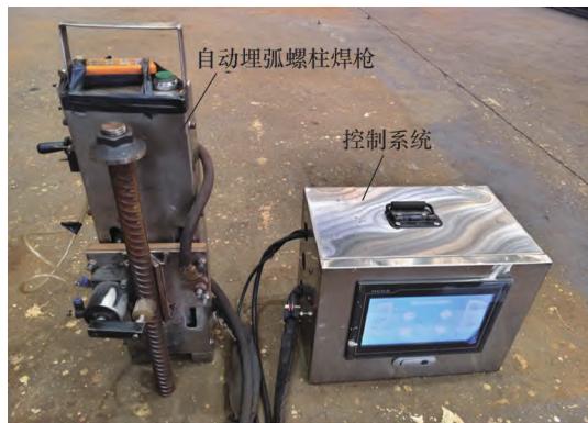
图6 自动埋弧螺柱焊枪及控制系统
