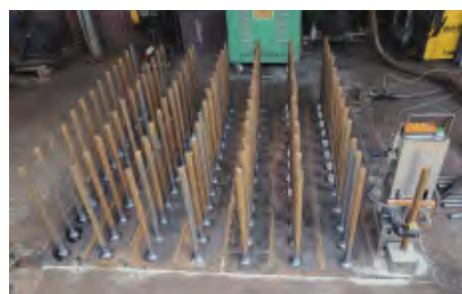
图8 批量模拟焊接试验
