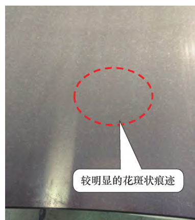
图9 3#行星轮渗碳淬火后磨削0.5mm
