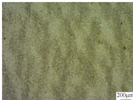
图16 试块1内孔枝晶状花斑较明显处 (50×)
