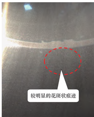
图12 4#行星轮渗碳淬火后磨削0.5mm
