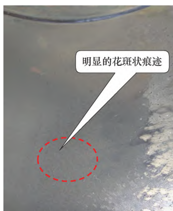
图7 2#行星轮精加工后
