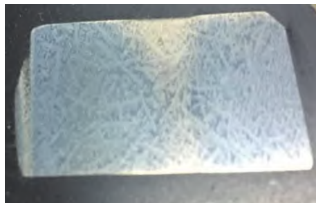
图14 试块1内孔枝晶状花斑较明显处
