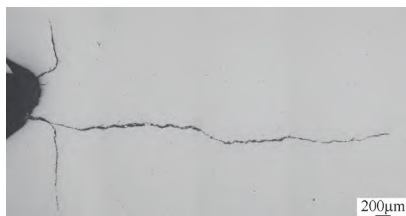
a) 横向花键齿裂纹抛光态形貌
