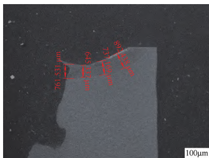
g) 纵向花键轴渐开线处硬化层深度
