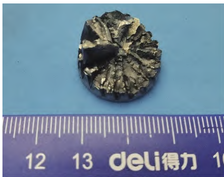
b) 断裂花键轴宏观形貌
