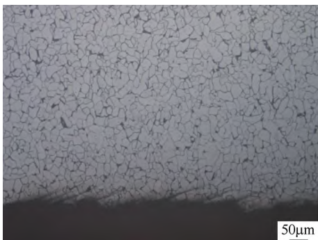
a) 风机盘管管道内壁
