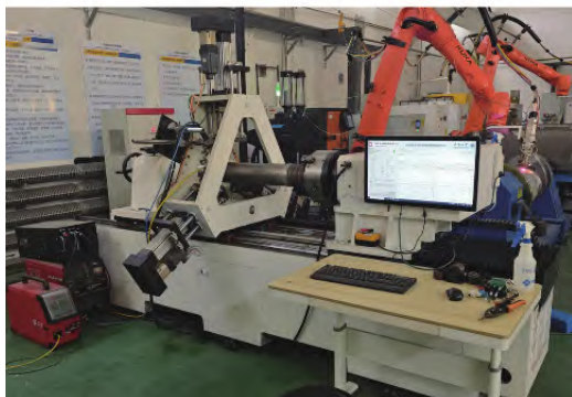
图1 复合电弧增材再制造平台
