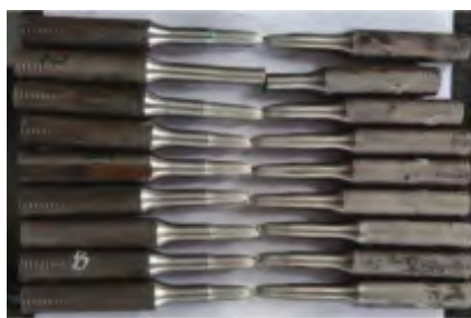
图6 拉伸断裂试件宏观形貌
