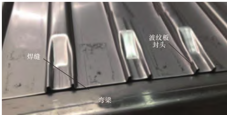
图1 波纹板与弯梁搭接实际结构
