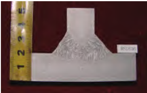
图4 试样焊缝断面宏观形貌
