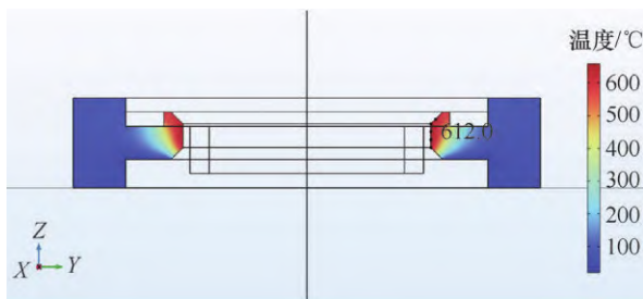
图7 零件轴向截面温度分布
